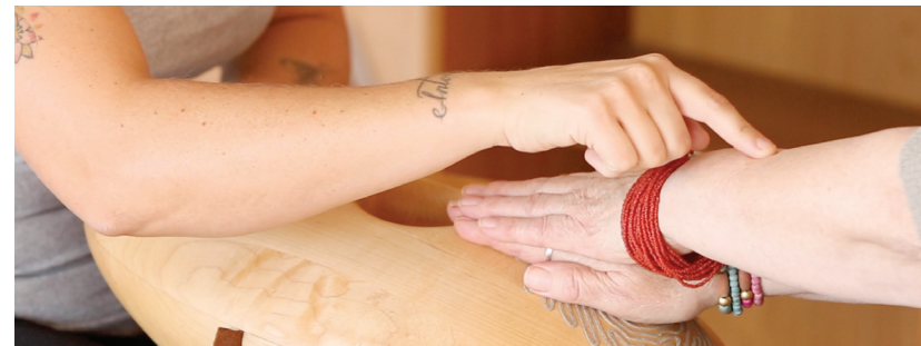
Fig. 3b: Een gesloten circuit wordt gevormd zodra gebruikers een hand op het aanraakvlak van de CRDL leggen en elkaar aanraken.
